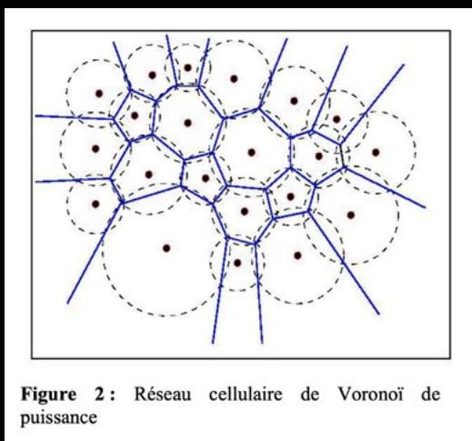
Figure 2 : Réseau cellulaire de Voronoï de puissance
